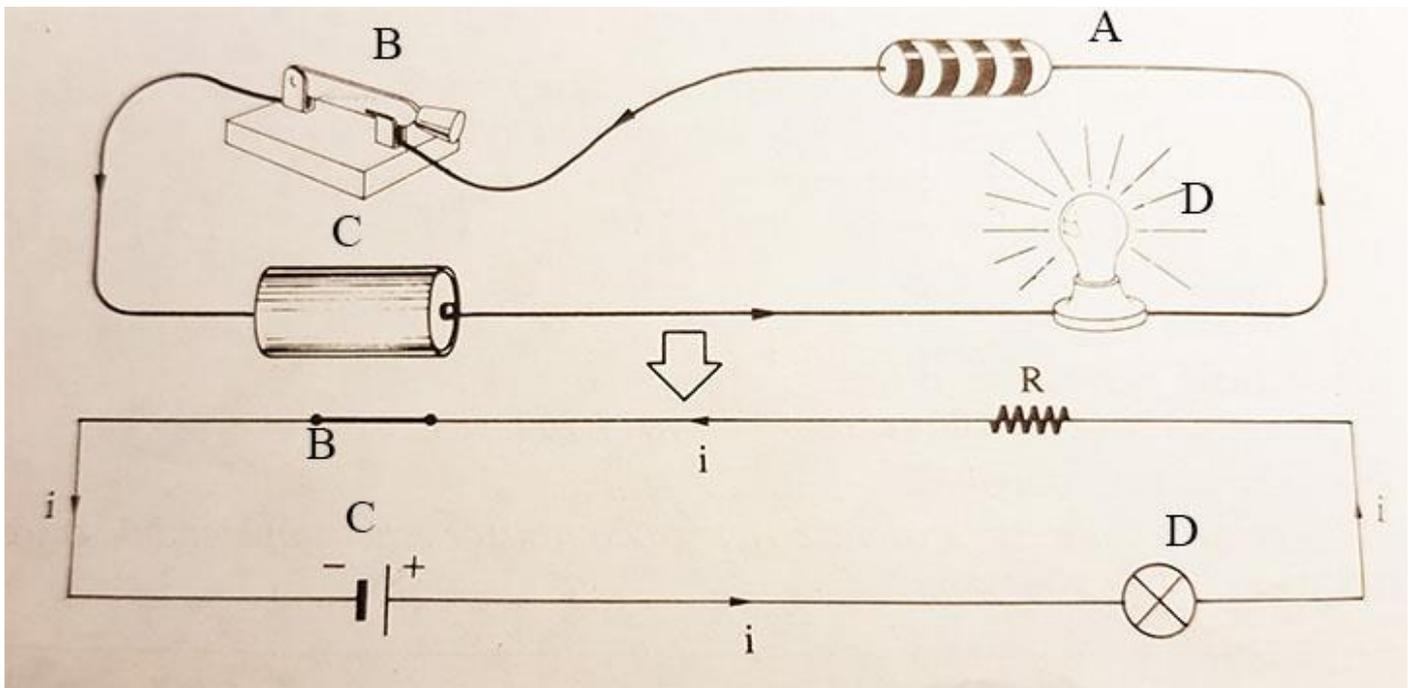
356. La figura dada representa un circuito real y el mismo, simbólico, con una resistencia de carbono, un interruptor, una pila y una bombilla que se corresponden sucesivamente con las letras:
