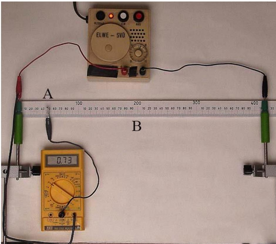
360. En el montaje de la figura, se representa una resistencia de hilo. Cuando el cursor se conecta en el punto A, el voltímetro indica 0,73V. Si se desplazara hasta el punto B, indicaría cerca de :
