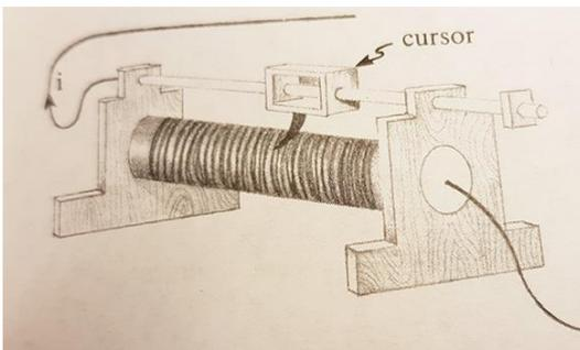
351\*. La resistencia variable dada en el dibujo deberá ser considerada una resistencia:
